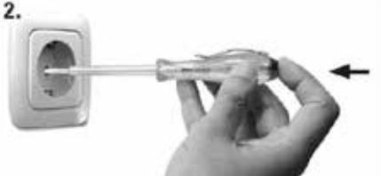
Izolovanou rukojet fázového testera držte tak, jak je vyobrazeno na obrázku. Měřící hrot **1** umístěte do elektrického obvodu, přičemž musí být vždy dodržen vhodný rozsah napětí. Dotkněte se holým prstem pólu **3** a sledujte douthavku **2**:
