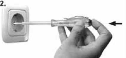
Držte izolovanú rukoväť fázovej skúšačky tak, ako je znázormené. Skúšobný hrot **1** umiestnite do elektrického obvodu, príčom vždy dodržiavajte vhodný rozsah napäťia. Dotknite sa holými prstami pólu **3** a sledujte tieľivku **2**:
