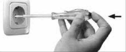
Tineti mânerul izolat al testerului de fază conform ilustrației. Plasați vârful testerului 1 într-un circuit electric, respectând întotdeauna intervalul de tensiune corespunzător. Atingeți polul 3 cu degetul gol și observați lampa cu incandescență 2:
