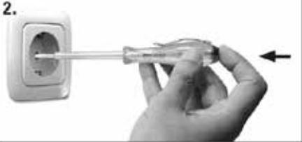
Izolovanou rukojeť fázového testera držte tak, jak je vyobrazeno na obrázku. Měřící hrot **3** umístěte do elektrického obvodu, přičemž musí být vždy dodržen vhodný rozsah napětí. Dotkněte se holým prstem pólu **1** a sledujte douthavku **2**:
