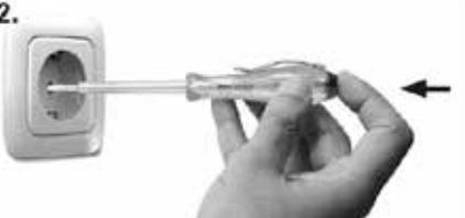
Držte izolovanú rukoväť fázovej skúšačky tak, ako je znázornené. Skúšobný hrot 3 umiestnite do elektrického obvodu, príčom vždy dodržiavajte vhodný rozsah napäťia. Dotknite sa holými prstami pólu 1 a sledujte tlejivku 2:
