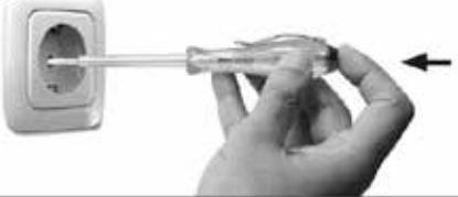
Håll fastestaren i det isolerade greppet enligt bilden. Placera mätspetsen **3** i en elektrisk krets. Det är viktigt att alltid säkerställa att spänningsområdet är korrekt. Vidrör polen **1** med ett naken finger och iaktta glimlampan **2**:
