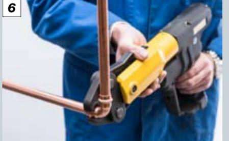
6 Pressvorgang starten. **Achtung:** Sichere Verpressungen können nur mit komplett zusammengeführten Pressbacken erreicht werden!
