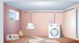
Zusammenfassung mehrerer Entnahmestellen an einem Strang
