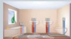
Zusammenfassung der Entnahmestellen in einer Ringleitung
